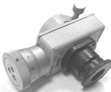
Рис. 2. Микрометр окулярный винтовой
